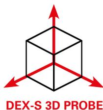
L'extenso-inclinomètre DEX-S est une sonde 3D avec l'association exclusive de deux capteurs: un inclinomètre MEMS biaxial de haute précision pour détecter les déplacements horizontaux, et un capteur magnétique sans contact pour détecter les déplacements verticaux.
